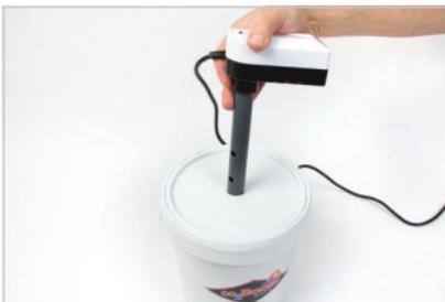
2. Ritirare la sigillatura e inserire il tubo con la pompa nel secchio
