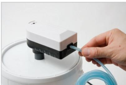
3. Führen Sie den Silikonschlauch in die Pumpe ein.
